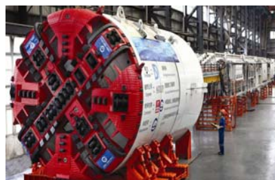
盾构工厂组装调试照片
